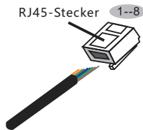
Abbildung 3.22 Isolierung entfernen und an RJ45-Stecker anschließen
